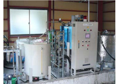
平成19年4月から稼働している精製施設。回収してきた廃食油を一日約200ℓ精製しています。
